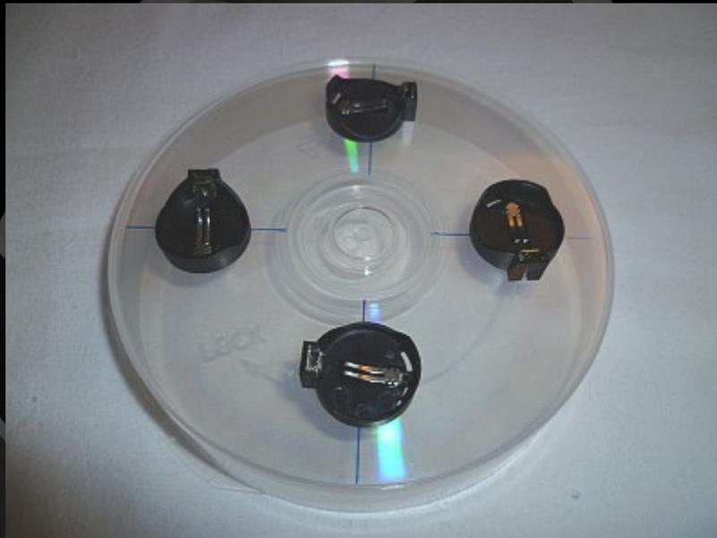
5. Die Batteriehalterungen mit doppelseitigem Klebeband befestigen, kurze Kabel zuschneiden und die Kabel mit den Batteriehalterungen verbinden (Reihenschaltung) (Schere, Seitenschneider, Lötkolben, Abisolierzange oder scharfes Messer).
