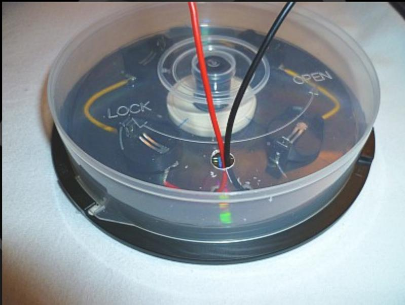
8. 2 ca. 3 cm lange Schrumpfschlauchstücke zurechtschneiden und über die noch offenen Kabelenden ziehen. Den Stecker des Routernetzteils abschneiden und an die Kabelenden unserer Batterie anlöten (dabei die Polung beachten) (Schere, Seitenschneider, Abisolierzange oder scharfes Messer, Lötkolben, Föhn oder Feuerzeug).
