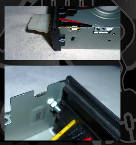
Die Gehäuseschrauben werden angebracht und fertig ist unser Fronteinschub. Mittels Feingewindeschrauben mit dem das CD- oder DVD-Laufwerk angebracht war, kann es in fast jedes beliebige PC-Gehäuse eingebaut und die einzelnen Adapter an das Mainboard angeschlossen werden.
