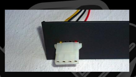
Einbau des SATA Verlängerungskabels. Das Kabel wird von der Slotblende entfernt, das Loch für die Buchse gefeilt und die Löcher für die Halterungsschrauben gebohrt (diverse Feilen, Bohrmaschine, Kreuzschlitzschraubendreher).
