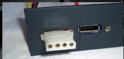
Einbau des Front – USB – Adapters. Als Verbindungen dienen Schrauben M3 – 10 mit Muttern (Bohrmaschine, diverse Feilen).
