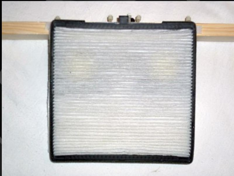
Der Nachteil ist, dass durch den Auto Innenraumfilter der Luftstrom reduziert wird. Das kann durch entsprechend mehr oder stärkere Lüfter ausgeglichen werden.
