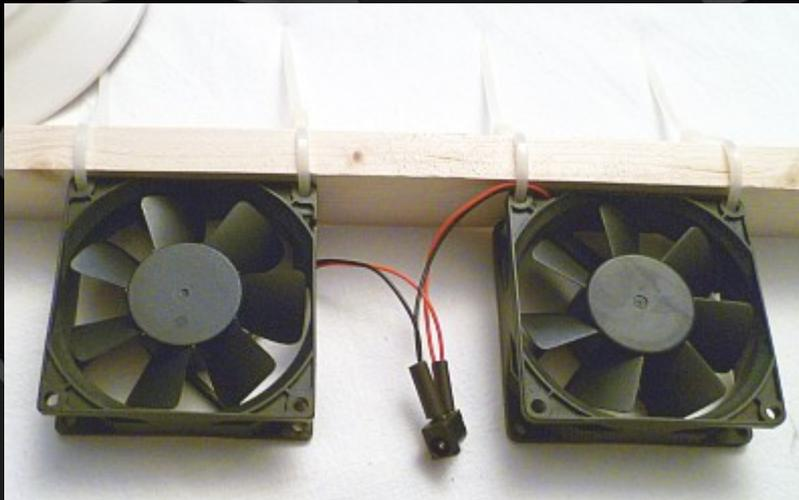
7. Die Schrumpfschläuche schrumpfen lassen, die Buchse mittels Kabelbinder anbringen, die Kabelbinder festziehen und mittels Seitenschneider kürzen (Föhn oder Feuerzeug, Seitenschneider).
