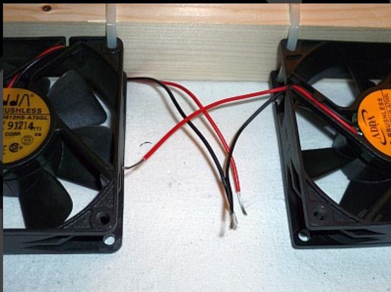
6. Kurze Schrumpfschlauchstücke über die Kabelenden ziehen und die ausgebaute Buchse an die Kabelenden anlöten (LötKolben).
