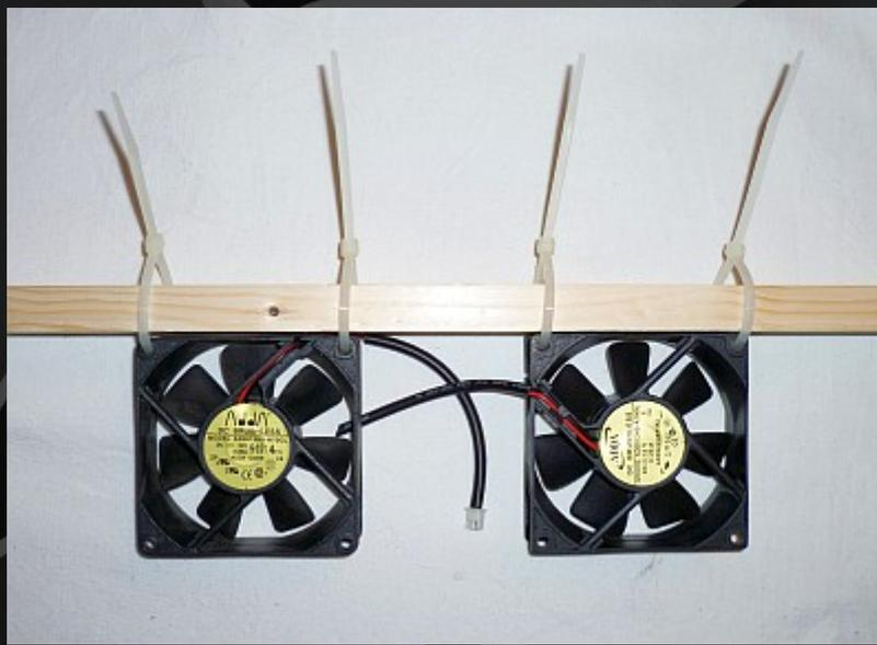
5. Zusammenlöten der entsprechenden Enden der Lüfter (rot – rot, schwarz – schwarz) (Abisolierzange oder scharfes Messer, Lötkolben).
