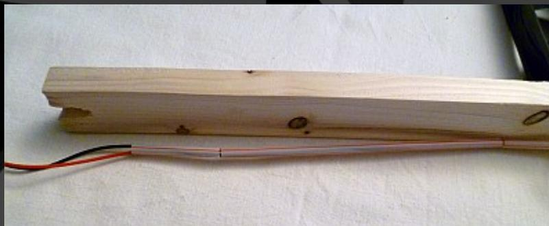
4. An dieser Stelle wird es ein wenig knifflig. Jetzt wird die Netzteilbuchse an den Kabelenden angebracht. Dazu werden vorher wieder Schrumpfschläuche über die Kabelenden gezogen, die Kabel auf die richtige Länge gestutzt und angelötet. Es muss aber noch so viel Spielraum bleiben, dass die Buchse in ihre Halterung passt. Die Buchse habe ich mittels Heißkleber im Loch der Holzlatte fixiert (LötKolben, Abisolierzange oder scharfes Messer, Heißklebepistole, Föhn oder Feuerzeug).
