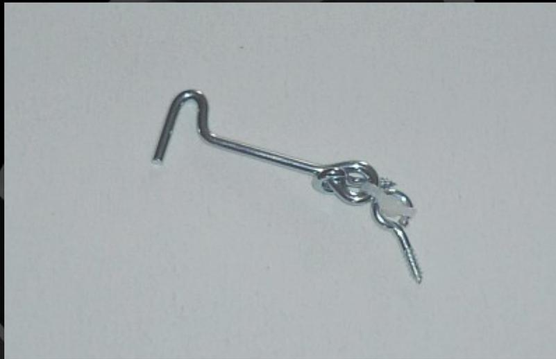
2. Grundidee: Um den Heizungslüfter Auf- und Abbauen zu können, dürfen keine Werkzeuge verwendet werden. Um einen weiteren Heizungslüfter anstecken zu können, wird ein reines Steck- und Hakensystem verwendet.
