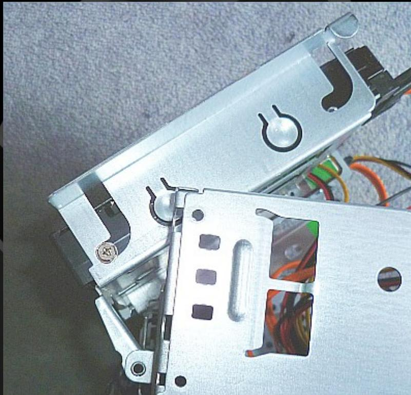
7. Der Einbau des Mainboards. Die Position und der untere Abstand des Mainboards wurden ja bereits von mir festgelegt. Die doppelte Abstandshalter (aus dem alten PC – Gehäuse) werden an das Gehäuse montiert (Bohrmaschine, Zange).
